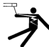
**CHOQUE ELECTRICO -- El contacto con las partes eléctricas energizadas y tierra puede causar daño severo o muerte. NO use soldadura de corriente alterna (AC) en áreas húmedas, de movimiento confinado en lugares estrechos o si hay posibilidad de caer al suelo.**
