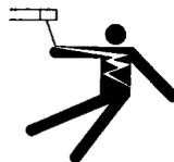
**CHOC ÉLECTRIQUE -- Le contact avec des pièces électriques ou les pièces de mise à la terre sous tension peut causer des blessures graves ou mortelles. NE PAS utiliser un courant de soudage c.a. dans un endroit humide, en espace restreint ou si un danger de chute se pose.**
