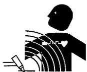
**CHAMPS ÉLECTRIQUES ET MAGNÉTIQUES — comportent un risque de danger. Le courant électrique qui passe dans n'importe quel conducteur produit des champs électriques et magnétiques localisés. Le soudage et le courant de coupage créent des champs électriques et magnétiques autour des câbles de soudage et l'équipement. Par conséquent :**
