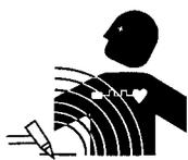
**CAMPOS ELECTRICOS Y MAGNETICOS - Son peligrosos. La corriente eléctrica fluye a través de cualquier conductor causando a nivel local Campos Eléctricos y Magnéticos (EMF). Las corrientes en el área de corte y soldadura, crean EMF alrededor de los cables de soldar y las máquinas. Por lo tanto:**
